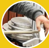
Le Skybender est équipé de protections pour garantir que le coude du tuyau est parfaitement plié à 90 degrés à chaque fois.
